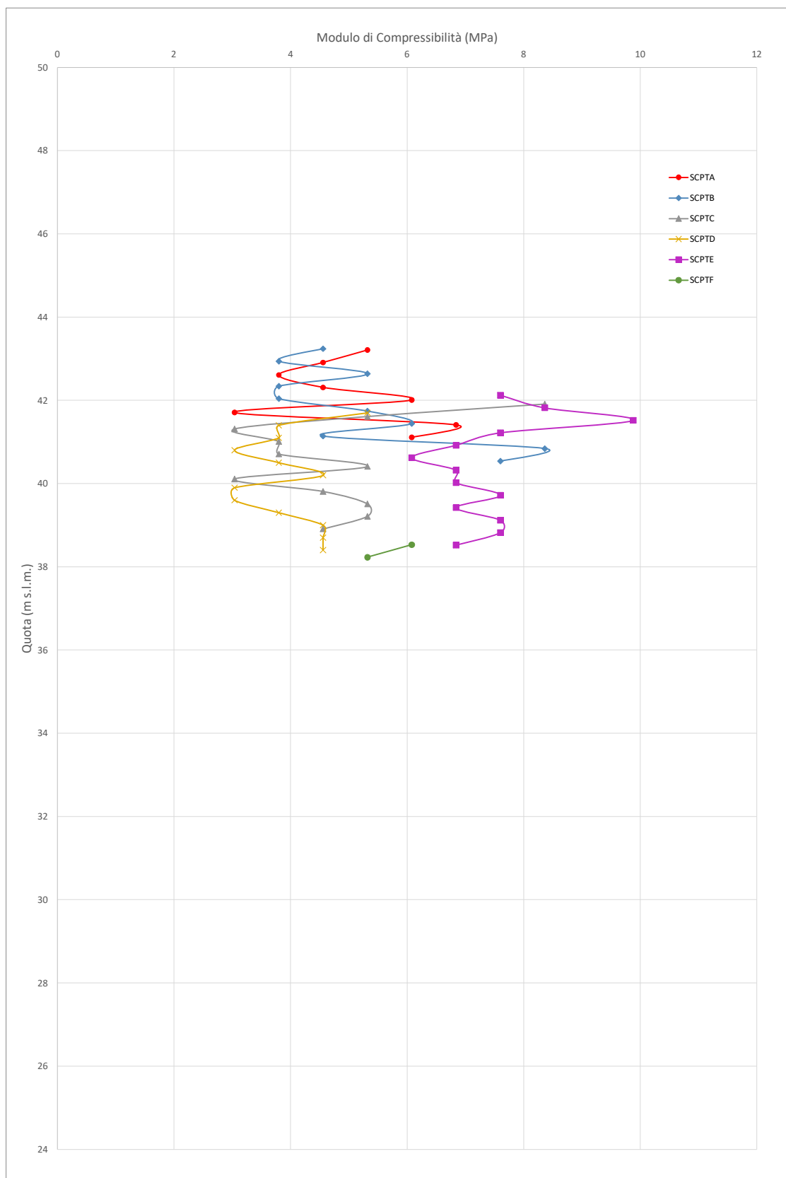
Figura 5.14. Modulo di compressibilità dei terreni naturali (sotto al rilevato) a comportamento coesivo.
